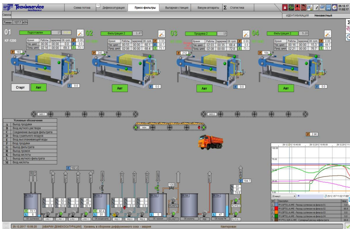
1.5 Сурет – Қант өндірісіндегі пресс-сүзгі бөлімінің автоматтандырылған сұлбасы
